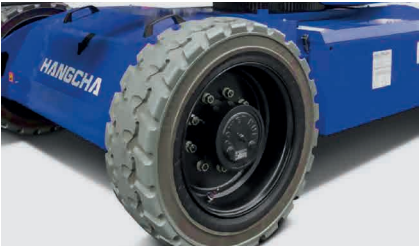
Ruote anti traccia riempite con schiuma per ottenere performance ideali nel fuori strada
